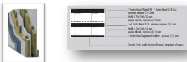
Figura 2 - Schema parete Knauf Aquapanel Outdoor (esempio A) Per l'esempio A l'isolante interno alle intercapedini è costituito da un pannello in lana minerale di spessore 80 mm e densità 100 kg/m 3 verso l'interno e da un pannello in lana minerale di spessore 80 mm e densità 100 kg/m 3 verso l'esterno. La parte complessivamente raggiunge uno spessore di cm. 27,9 con trasmittanza termica pari ad U=0,1905 \text{ W/m}^2\text{k} .
